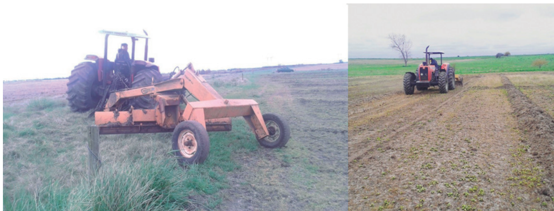
Figura 2. Pala de cola utilizada para construir los bordos de las melgas.
